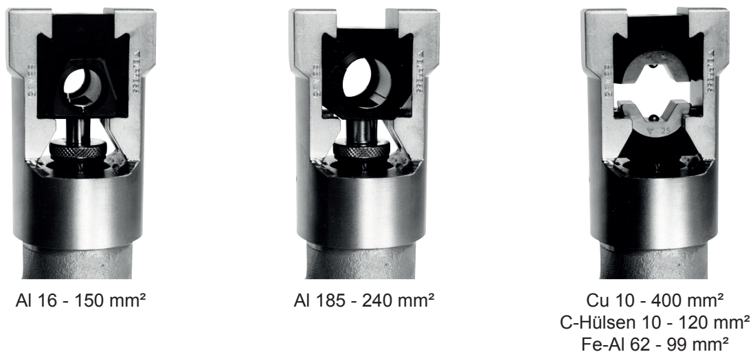
Fig. 1. Montierte Werkzeuge in die Pumpe V1311-A.
